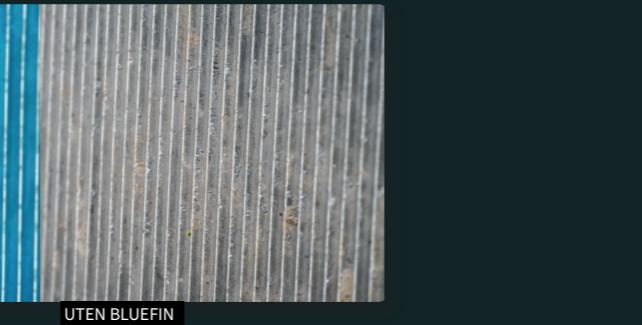
Bildene over viser 2 år gamle varmevekslere. Den til venstre med Bluefin er fortsatt som ny. Bildet til høyre, viser pumpe uten korrosjonsbelegg, som har fått dårligere energioverføring grunnet isolerende korrosjon.
